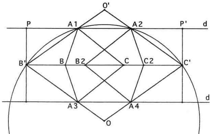
Avec le point A<sub>2</sub>, j'obtiens le triangle A<sub>2</sub>B<sub>2</sub>C<sub>2</sub> symétrique du triangle A<sub>1</sub>BC par rapport à la médiatrice de (B'C').
