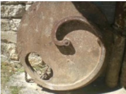
À l'entrée du fort est présenté un contrepoids du système d'ouverture de la porte blindée. Cette spirale semble être formée de demi-cercles assemblés. Il est tentant d'imaginer un programme de construction permettant de la retracer puis de la compléter.
