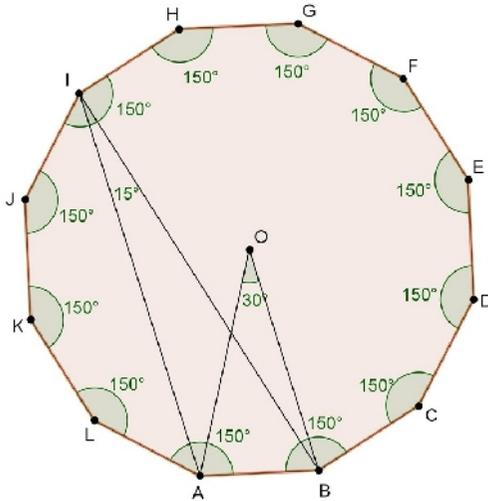
Dans un triangle, la somme des angles vaut  $180^\circ$  ; dans un quadrilatère qui se décompose en 2 triangles, la somme des angles vaut  $360^\circ$  ;.....; dans un dodécagone, la somme des angles vaut  $(12-2) \times 180^\circ$  soit  $1800^\circ$ .
