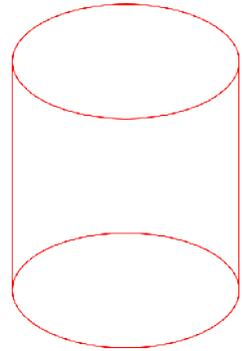
Il est vu en perspective « cavalière », ses faces supérieures et inférieures sont représentées par des ellipses, dont les axes sont manifestement parallèles aux bords de la feuille de dessin.
