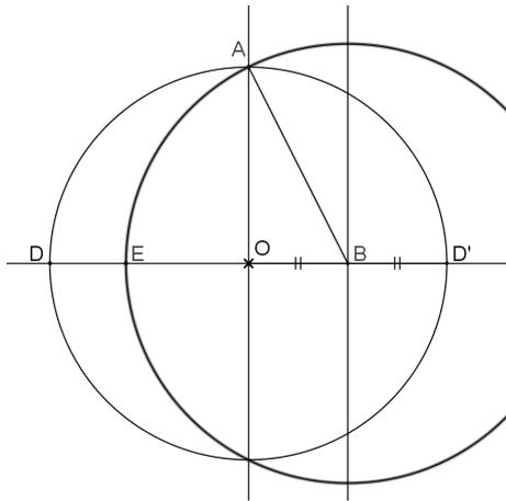
7) Tracer le cercle de centre B et de rayon AB. Il coupe le diamètre horizontal en E.
