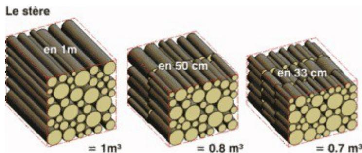
Pour quantifier cela, on définit le coefficient d'empilage qui est le volume de bois plein présent dans un stère :  $CE = \frac{\text{m}^3_{\text{bois plein}}}{\text{m}^3_{\text{apparent}}} = \frac{\text{m}^3_{\text{bois plein}}}{\text{stère}}$
